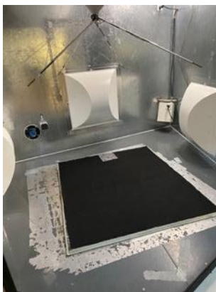
Figure 4 : Cabine réverbérante type Alpha
