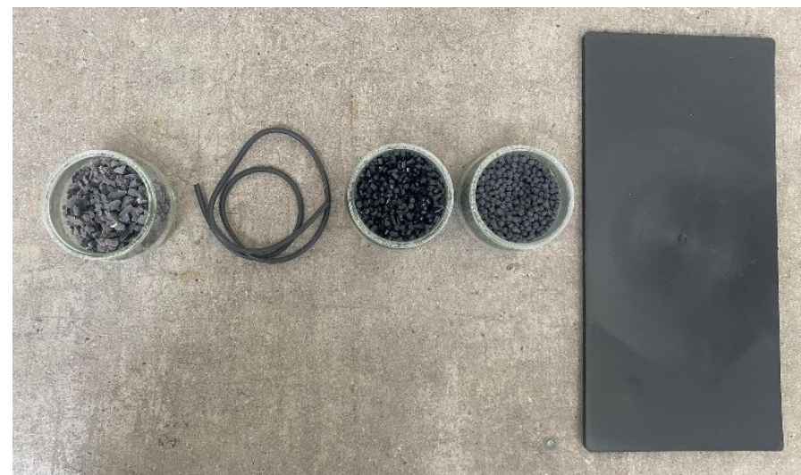
De gauche à droite : matière broyée, jonc d'extrusion, granulé recyclé, granulé vierge et plaque injectée contenant 50% de matière recyclée
