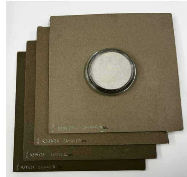
Caoutchouc micronisé et plaques injectées contenant différents taux de matière recyclée
